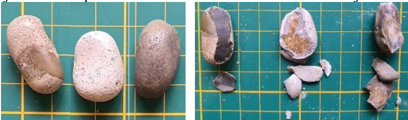
Fig. 2-3. Links de nieuwe slachtoffers en rechts de resultaten: Links 1 klap met gewei 340 op aambeeld 3.000+ Midden 2 klappen met gewei 793 op aambeeld 3.000+; Rechts met gewei 1.006 op aambeeld 3.000+ geen slijting, vervolgens slijting na 2 klappen met gewei 793.
