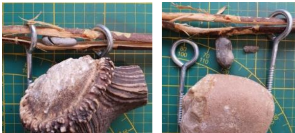
Fig. 19. Links onsuccesvol met lichte wel succesvol met zware geweihamer, rechts onsuccesvol met licht en zware geweihamer en ultra lichte stenen hamer uiteindelijk succesvol met middelzware stenen hamer op licht stenen aambeeld.
