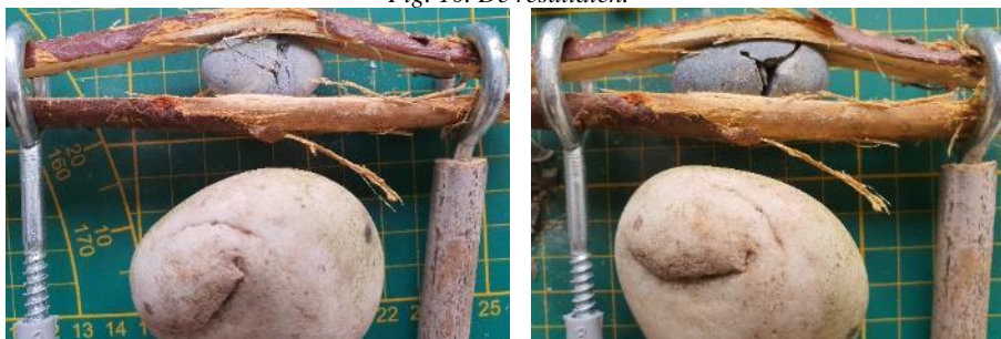
Fig. 11. Na onsuccesvolle pogingen met ultra lichte hamer met lichte hamer geslagen, beide vuursteen.
