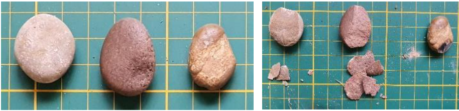
Fig. 2-2. Links de slachtoffers en rechts de resultaten van de 2 e sessie: Links geweihamer 340 op aambeeld 3.000+ slijting na 1 klap; Midden geweihamer 793 op aambeeld 3.000+ geen slijting na 10 klappen, slijting na 5 klappen met stenen hamer 417 op aambeeld 3.000+; Rechts geweihamer 1.006 op aambeeld 3.000+ slijting vanuit aambeeld na twee klappen.
