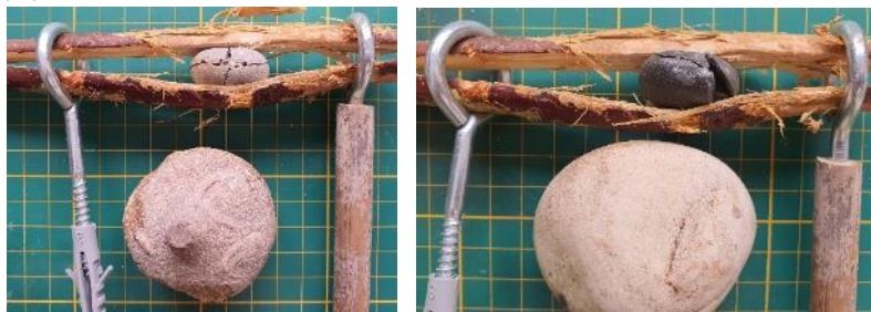
Fig. 48. Links succesvol, vuursteen; rechts onsuccesvol met ultra lichte hamer, vuursteen met insluiting, lichte hamer.
